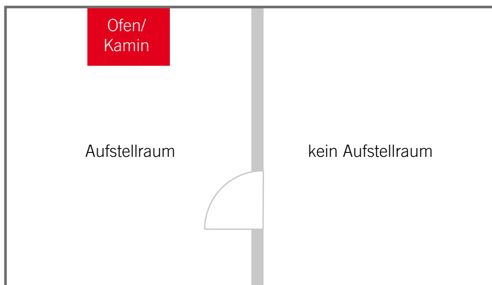
Abbildung 1: Einzelraumfeuerungsanlage im Aufstellraum
