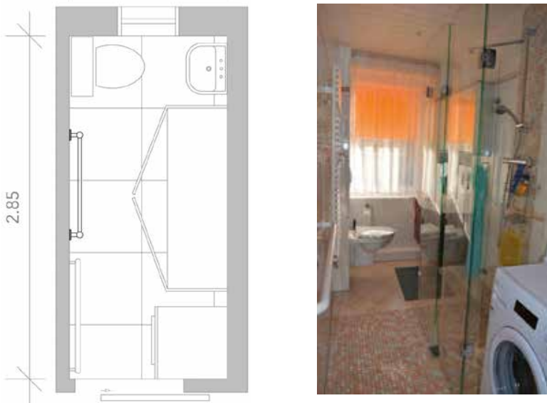
Abb. 3.7: Altersgerecht umgebautes Bad für die Pflege eines Herrn im Rollstuhl, versorgt von seiner Ehefrau (Grundriss: DLW, Foto: SIBIS)
