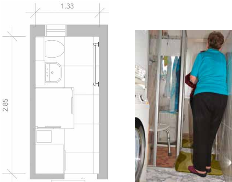
Abb. 3.3: Mobilitätseingeschränkte Bewohnerin in altersgerecht umgebauten Altbaubad (Grundriss: DLW, Foto: SIBIS)
