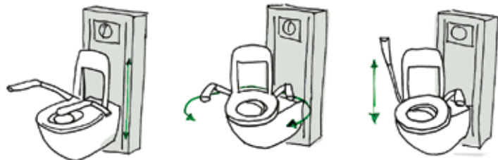
Abb. 4.6: Drehbare Toilette (Grafik: ZVSHK)
