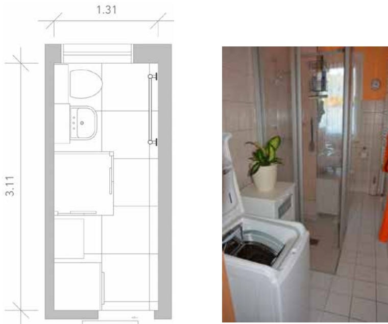
Abb. 3.5: Altersgerecht umgebautes Bad für pflegebedürftiges Ehepaar (Grundriss: DLW, Foto: SIBIS)
