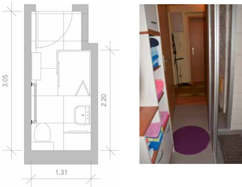
Abb. 3.6: Altersgerecht umgebautes Bad für Rollatorgängerin, betreut vom ambulanten Pflegedienst (Grundriss: DLW, Foto: SIBIS)
