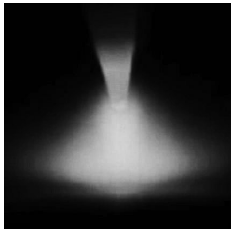
HYPER.PULS-Lichtbogen - deutlich erkennbare Bündelung
