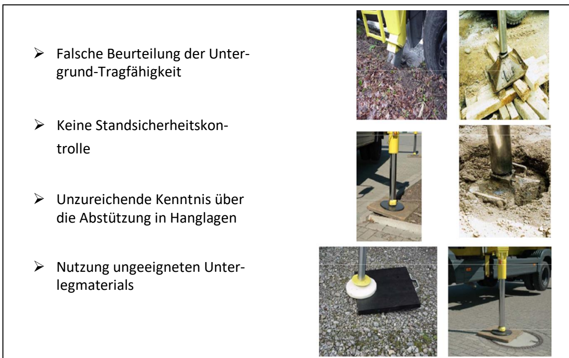
Abbildung 10: Beispielhafte Gründe für ein Umkippen einer Hubarbeitsbühne
