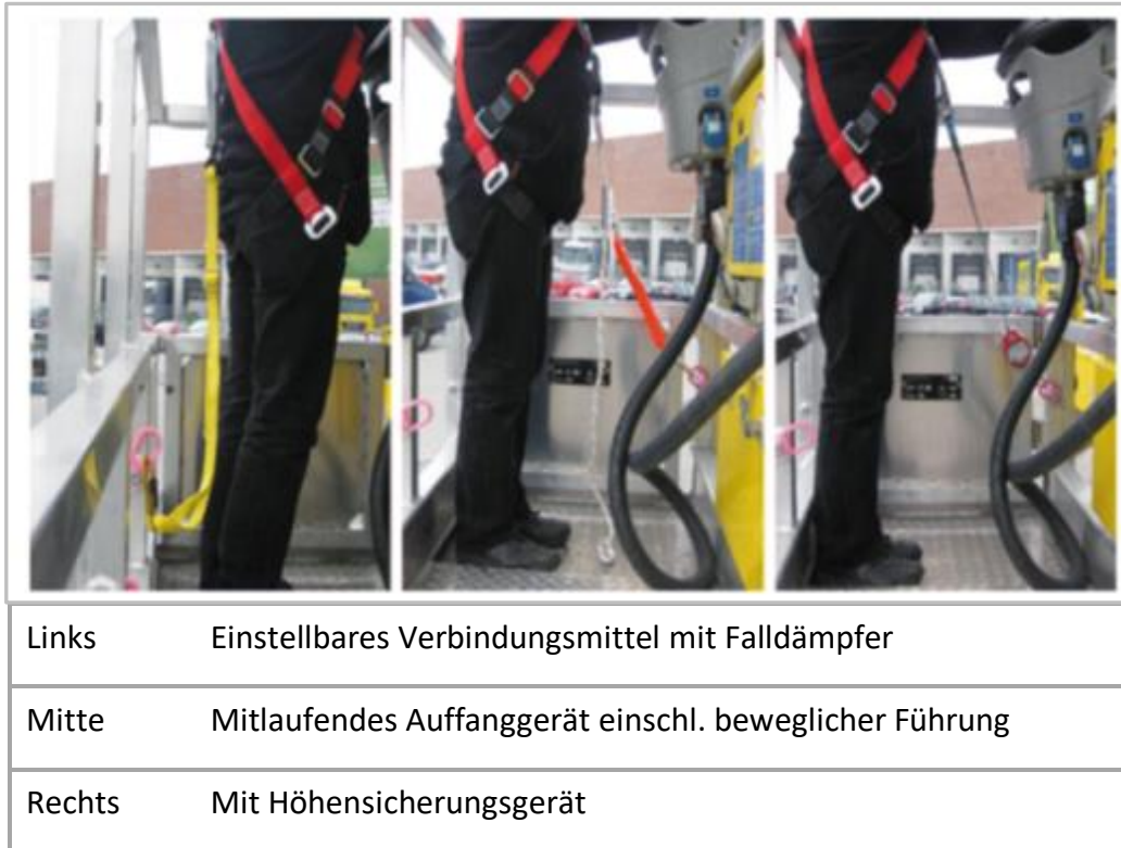
Abbildung 12: Spezielle Sicherungssysteme für fahrbare Hubarbeitsbühnen auf Basis herkömmlicher Auffangsysteme, Bilder: Schäper, Technische Sicherheit, Band 3 (2013), S. 47 ff
